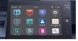
Pantalla táctil intuitiva a color tipo tableta de 10,1 pulg.: se puede personalizar y permite realizar tareas en unos pocos pasos. Pruébela en [xerox.com/SIM7](http://xerox.com/SIM7).
